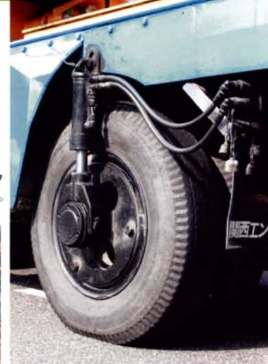
◀前後移動シリンダー 支柱打ち込み位置のズレを調整。 (シリンダーストローク 300 mm)
