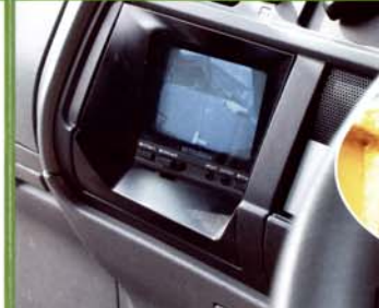
◀モニターテレビ・カメラ 支柱間隔のズレを、移動しながら同時修正。
