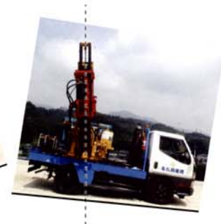
▲勾配対応回転ドラム 回転ドラムにより道路勾配にも対応。施工精度と作業安全性の革新的な向上。
