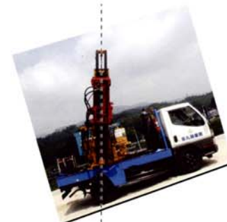
◀自動停止装置 支柱が規定寸法に達すると自動的に停止。
