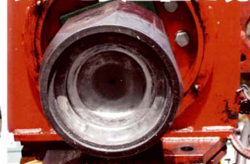
▲打ち込みキャップ 万能キャップによりボックスビーム、ガードパイプ、ガードレール（A・B・Cタイプ）を打ち込み可能。
