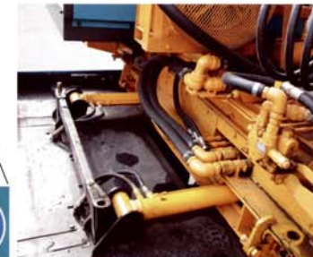
▶スプリングロック 車両の傾きを防ぎ、自走しながら連続打ち込み。アウトリガーを不要とし、大幅な効率化。
